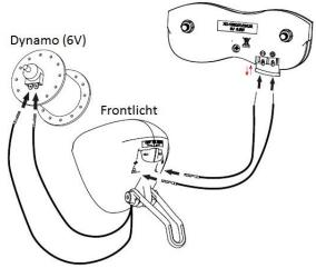
Das Rücklicht kann grundsätzlich sowohl an Naben- als auch an Seitenläufer-Dynamos angeschlossen werden die 6 V produzieren.
