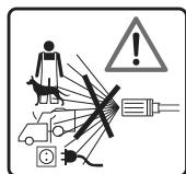
Hochdruckstrahlen können bei unsachgemäßem Gebrauch gefährlich sein. Der Strahl darf nicht auf Personen, Tiere, aktive elektrische Ausrüstung oder auf die Maschine selbst gerichtet werden.
