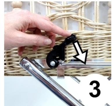
*Unsere Lederriemengestelle sind mit einer zusätzliche Falle an der Aufsatzschiene ausgestattet – diese ist durch einfaches Anheben beim Herausnehmen des Oberteiles zu lösen. Beim Einsetzen schließt sich die Falle automatisch.*
