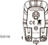
Beim Anschluss von Kabeln mit Kabelschuhen erfolgt dies über die Anschlüsse 1 und 2. Beim Anschluss der Kabel ohne Kabelschuhe Knopf 3 gedrückt halten und die anisierten Kabel jeweils rechts und links in die vorgesehenen Öffnungen stecken. Durch Loslassen von Knopf 3 werden die Kabel dort fixiert.
