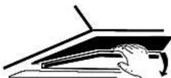
Entfernen Sie den/die Fettfilter. Die Kohlefilter werden auf den beiden Seiten des Motorgehäuses befestigt.
