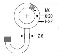
**HKC** C-Haken für Edelstahlstangen bis  $\varnothing 18$  mm, Edelstahl massiv, gebürstet.
