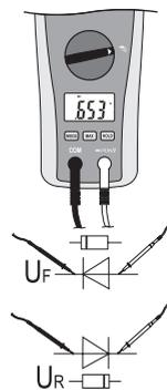
→ Siliconediodes hebben in ingeschakelde status een spanning (UF) van ongeveer 0,4 – 0,9 V.
