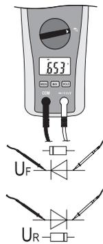
→ Les diodes au silicium ont une tension de conduction (UF) d'env. 0,4 à 0,9 V.
