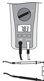
→ Als u een weerstandsmeting uitvoert, zorg ervoor dat de meetpunten die u aanraakt met de testsondes vrij zijn van vuil, olie, soldeerbaar lak en dergelijke. In dergelijke omstandigheden kan een verkeerde meting ontstaan.
