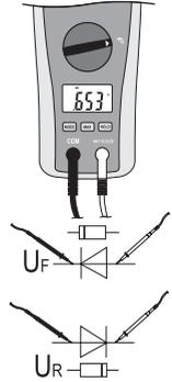
→ Silikondioden weisen einen Spannungsabfall von etwa 0,4 – 0,9 V (UF) in Durchlassrichtung auf.
