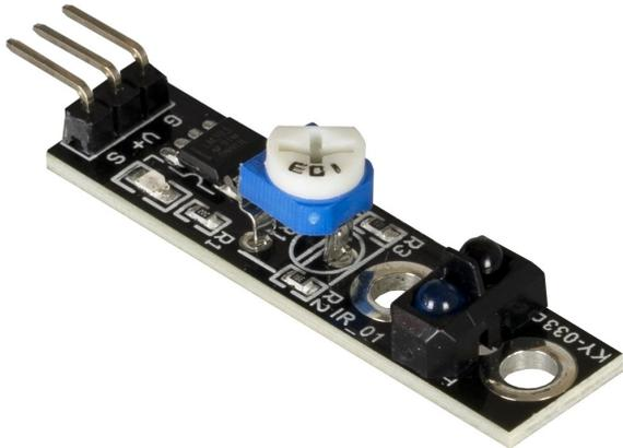
Dieser Sensor sendet und empfängt Infrarot. Dabei kann er erkennen, ob er eine reflektierende Fläche (der Sensor empfängt sein eigenes Signal) oder eine absorbierende Fläche (der Sensor empfängt kein Signal) vor sich hat. Dabei kann man die Empfindlichkeit des Sensors mit Hilfe eines Potentiometers einstellen.
