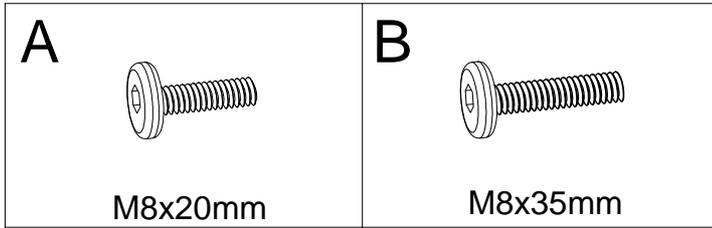
DE:Bitte beachten Sie, dass die Formen der Schrauben A und B ähnlich sind. Bitte installieren Sie entsprechend der Anleitung und unterscheiden Sie sie!
