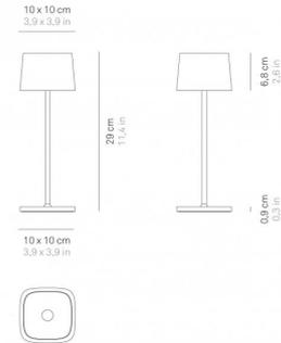
Ofelia pro è una lampada a batteria portatile e ricaricabile da tavolo. È dotata di: base di ricarica a contatto, touch dimmer e della funzione di memoria dell'impostazione di dimmerazione che memorizza gli step di dimmerazione. Di conseguenza, ad ogni accensione, l'intensità luminosa corrisponderà a quella precedentemente impostata. La lampada è dotata inoltre della funzione di selezione della temperatura di colore della luce tra 2700 e 3000° Kelvin (bianco dinamico).
