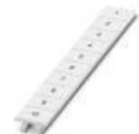
Zackband, Streifen, weiß, beschriftet, beschriftbar mit: CMS-P1-PLOTTER, quer bedruckt: fortlaufende Zahlen 1 ... 10, 11 ... 20 usw. bis 91 ... 100, Montageart: verrasten in hoher Schildchennut, für Klemmenbreite: 8,2 mm, Schriftfeldgröße: 10,5 x 8,15 mm, Anzahl der Einzelschilder: 10
