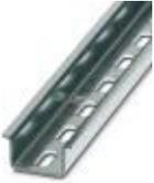
Tragschiene gelocht, Standardprofil, Breite: 35 mm, Höhe: 15 mm, ähnlich EN 60715, Material: Stahl, verzinkt, weiß-passiviert, Länge: 2000 mm, Farbe: silberfarben
