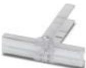
Klemmenleistenmarker, zur Leistenkennzeichnung, höhenverstellbar, zu verwenden bei Endhaltern E/UK, E/NS 35 N, oder CLIPFIX 35, Schriftfeldgröße: 44 x 7 mm
