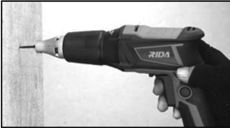
Befestigen Sie die Schraube an der Spitze des Bohrers und platzieren Sie die Spitze der Schraube auf der Oberfläche des zu befestigenden Werkstücks. Üben Sie Druck auf das Werkzeug aus und starten Sie es. Ziehen Sie das Werkzeug zurück, sobald die Kupplung einrastet. Lassen Sie dann den Auslöseschalter los.
