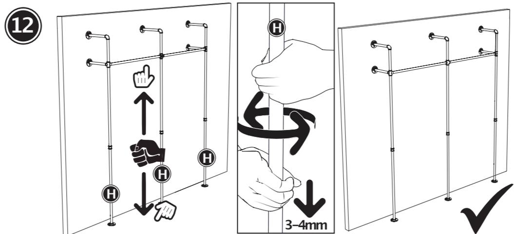
Zum Schluss Stange H ein wenig herausdrehen und gegen den Boden zu verspannen. Damit erhält man eine zusätzliche Stabilität und gleicht Unebenheiten im Boden aus.
