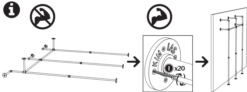
Nicht wundern, wenn die Teller in verschiedene Richtungen zeigen. Einfach beim an die Wand stellen die Teller in die gewünschte Position zurückdrehen. Die Stabilität kommt nach dem festschrauben an der Wand.
