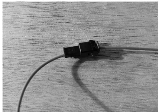
(4) Stecken Sie den Stecker des Antennenkabels ein.
