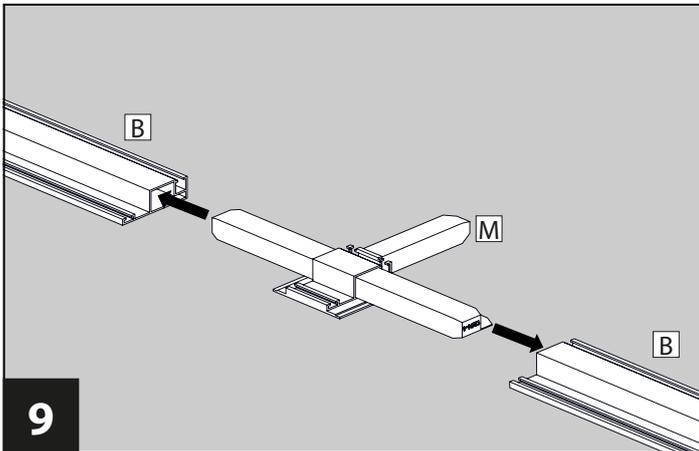
Verbinden Sie die Mittelverbinder **M** mit jeweils zwei Höhenprofilen **B**. Verwenden Sie bei Schwergängigkeit einen Gummihammer. **Achtung:** Die Bürstenkanäle an den Mittelverbindern dürfen nicht beschädigt werden.
