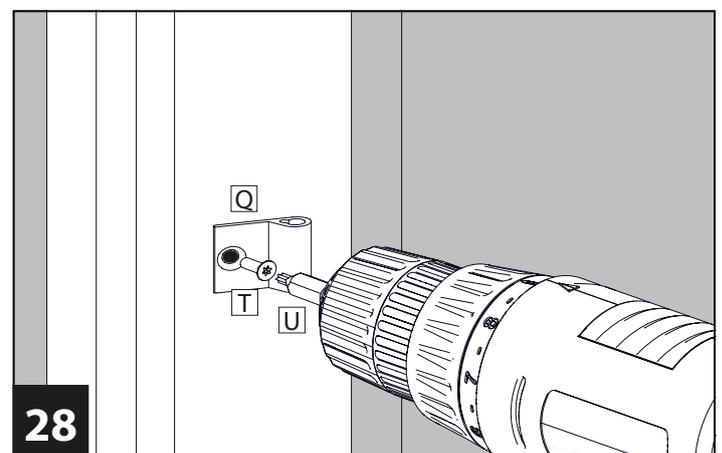
Befestigen Sie das obere und untere Scharnier **Q** mit den Schrauben **T**. Verwenden Sie dazu den Torx-Bit **U**.
