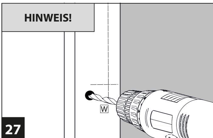
Bohren Sie die markierten Stellen mit einem  $\varnothing$  2,5 mm Bohrer vor (Je nach Untergrund richtigen Bohrertyp verwenden).
