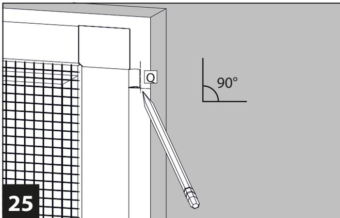
Setzen Sie den Insektenschutz in den Türrahmen und richten diesen im rechten Winkel (z. B. mit einer Wasserwaage) aus. Markieren Sie die Position des oberen und unteren Scharniers **Q** wie abgebildet.
