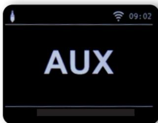
Nun können Sie Musik vom externen Gerät wiedergeben. Die Steuerung (Titel vor, zurück, Stop, Play) erfolgt hierbei über das angeschlossene Gerät, die Wiedergabe-Lautstärke kann über die **VOL+/VOL-** Tasten bzw. den Drehregler des Radios oder über das externe Gerät geregelt werden. Bitte beachten Sie, dass Sie zum Anschluss des externen Gerätes ein passendes Kabel benötigen.
