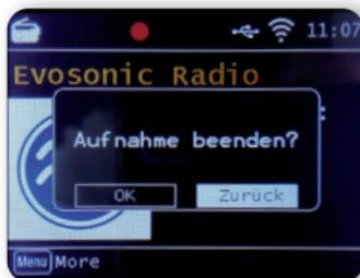
Mit dem Radio können Sie, ähnlich wie bei einem Video- oder DVD-Recorder auch Timeraufnahmen programmieren, um Radiosendungen aufzuzeichnen, wenn Sie z.B. nicht zu Hause sind. Halten Sie dazu die **Record** Taste am Gerät oder auf der Fernbedienung länger als 2 Sekunden gedrückt.
