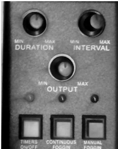
Mit den Drehreglern der Fernbedienung können Dauer, Intervall und Volumen des Nebelausstoßes angepasst werden. Ist der Output-Regler auf 0, sind alle Funktionen außer Kraft.
