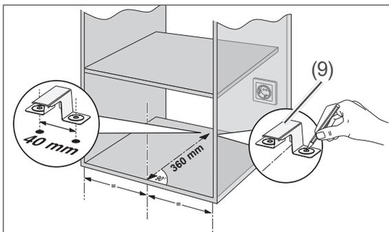
3. Legen Sie den Kippschutz (9) am Ende der Hilfslinie mittig an, und markieren Sie mit einem Stift die Positionen der Bohrlöcher. Die Bohrlöcher müssen 40 mm Abstand haben.
