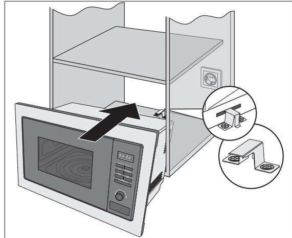
5. Schieben Sie das Gerät in das Einbaufach, bis die Frontblende auf dem Rahmen des Einbaufachs auftrifft.
