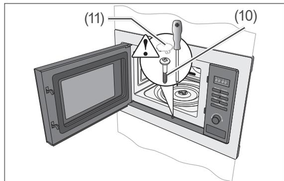
6. Sichern Sie das Gerät mit der dritten Schraube (10) gegen Herausrutschen.
