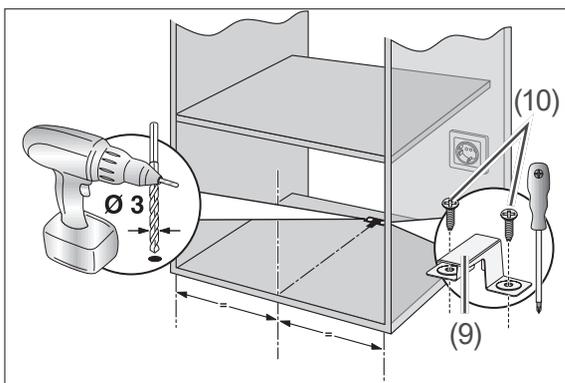
4. Bohren Sie die Löcher (Sie brauchen einen Bohrer der Größe 3 mm); legen Sie den Kippschutz erneut an, und schrauben Sie ihn mit zwei Schrauben (10) mit einem Kreuzschlitzschraubendreher fest.
