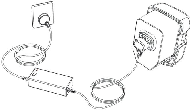
**Achtung:** Bei ein Temperatur über 48°C (118°F) darf der Akku nicht geladen werden. Um den Akku laden zu können müssen Sie diesen aus dem Scooter Gehäuse nehmen.
