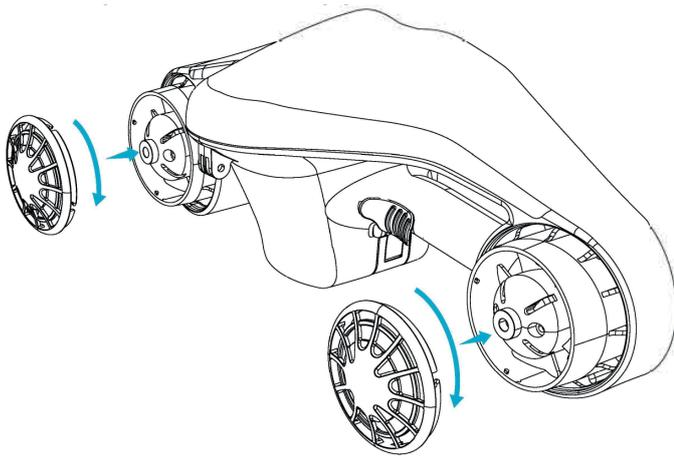
Richten Sie die Turbinen und Abdeckungen übereinander aus. Drehen Sie im Uhrzeigersinn bis ein Arretierungsgeräusch entsteht.
