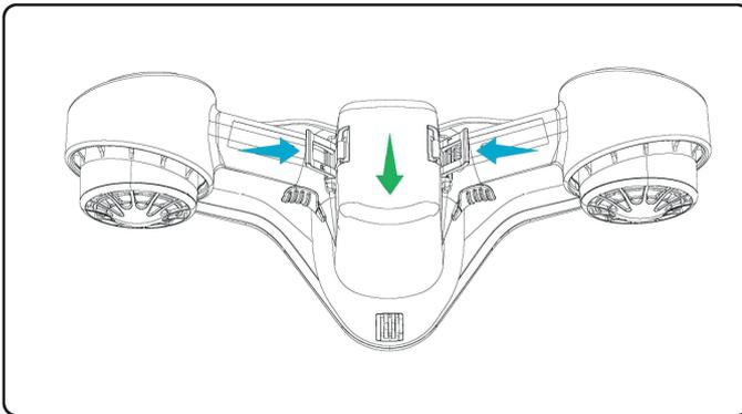
3. Der Akku richtet selbständig aus sobald Sie die Seitenriegel umklappen.
