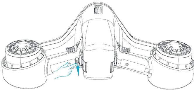
Setzen Sie den Scooter ins Wasser. Entriegeln Sie zunächst die Sperre, halten Sie den Hauptschalter und den Beschleunigungsschalter gedrückt um den Scooter zu starten. Durch loslassen eines der Schalter geht der wieder aus.
