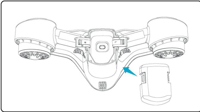
1. Setzen Sie den Akku in das Gehäuse ein.
