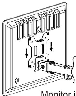
Schwenkarms in den Kopf des Monitor einsetzen.
