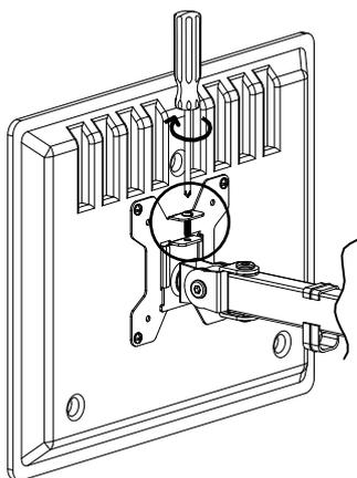
Drehe die Schrauben am Panel in die Schraubenlöcher am Kopf.
