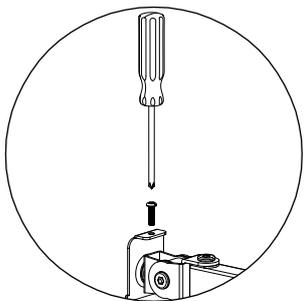
Vormontierten Schrauben lösen.
