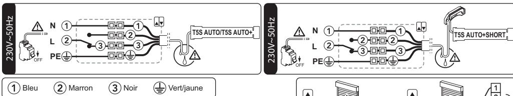
**⚠** - Possibilité de câbler 3 moteurs max. en parallèle sur un interrupteur.
