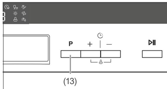
2. Halten Sie die Taste **P** (13) so lange gedrückt, bis im Display der aktuelle Härtegrad angezeigt wird: H1 bis H6.
