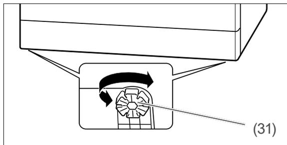
5. Um Unebenheiten des Bodens auszugleichen und das Gerät waagrecht auszurichten, können Sie die vier Stellfüße (31) heraus- oder hineindrehen. Die Stellfüße haben ringsherum Schlitze. Stecken Sie hier einen Schraubendreher hinein und drehen Sie damit den Stellfuß. Verwenden Sie zum Ausrichten des Geräts eine Wasserwaage.
