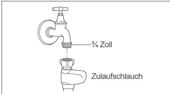
Für die Wasserversorgung benötigen Sie einen Wasserhahn mit einem  $\frac{3}{4}$  Zoll-Schraubanschluss.
