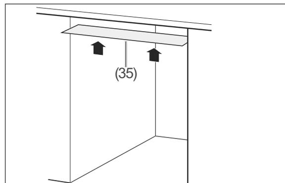
3. Kleben Sie die beiliegenden Schutzfolie für Kondenswasser (35) auf die Unterseite der Arbeitsplatte. So vermeiden Sie Schäden an der Arbeitsplatte aufgrund heißer Dämpfe, die bei geöffneter Gerätetür aus dem Gerät strömen.
