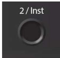
Die 6,35 mm Klinkenbuchsen für Kanal 2 können mit passiven Instrumenten wie Gitarre, Bass etc. belegt werden.
