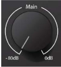
Der Main-Regler steuert den Ausgangspegel für die Main-Ausgänge Links/Rechts auf der Rückseite der AudioBox GO im Bereich von -80 dB bis 0 dB. Dieser Regler hat einen rein dämpfenden Effekt.
