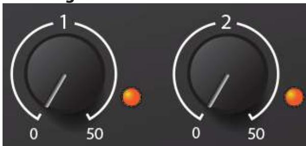
Diese Regler bieten eine variable Verstärkung von 50 dB (0 bis +50 dB für Mikrofone, -15 bis 35 dB für Line-/Instrumentensignale).
