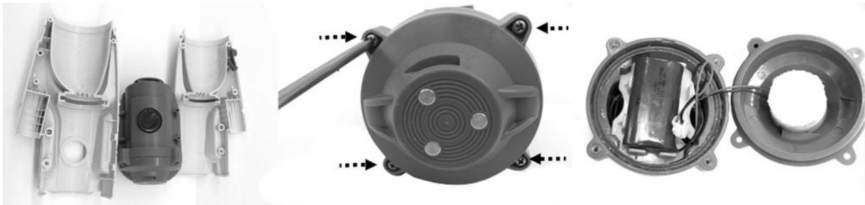
4. Verwenden Sie einen Kreuzschlitzschraubendreher, um die Schraube an der Ecke der geraden Trägerplatte zu lösen. Ziehen Sie die Platte mit einer Klemme heraus, um die Leiterplatte und ihre Kabelstecker freizulegen.
