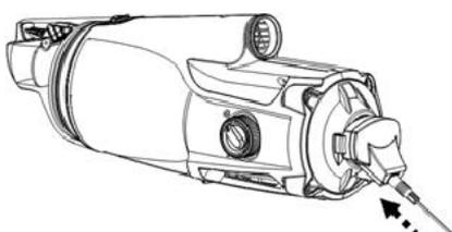
4. Verbinden Sie das externe Ladegerät mit der Stromversorgung. Nachdem der Poolsauger mit der Aufladung begonnen hat, leuchtet die Leuchtanzeige am externen Ladegerät rot. Normalerweise dauert ein vollständiger Ladevorgang 4-6 Stunden. Die Leuchtanzeige leuchtet grün, sobald der Poolsauger fast vollständig aufgeladen ist. HINWEIS: Falls der Motor Geräusche erzeugt, vergewissern Sie sich, dass am Ein-/Ausschalter "AUS" gewählt ist.
