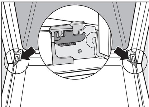
Die Tür ist durch Halterungen mit den Türscharnieren verbunden. Bevor Sie die Tür von diesen Halterungen abziehen können, müssen Sie erst die Sperrbügel an beiden Türscharnieren entriegeln.
