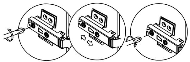
Dies wird verwendet, um die Türverkleidung in Vorder- und Rückrichtung einzustellen: Lösen Sie zuerst die Schraube und ziehen Sie dann die Schraube fest, nachdem Sie die Türverkleidung in die richtige Position eingestellt haben.
