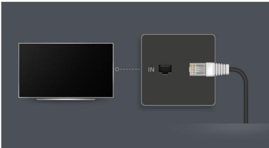
01 Schließen Sie den LAN-Anschluss des TV-Geräts über ein LAN-Kabel an den Router an.
