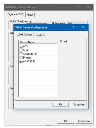
Der Screenshot links zeigt die Multichannel WDM Devices des Digiface AES nach Auswahl der Option 'Multi-Channel' im Feld WDM Devices, und Klick auf den Knopf WDM Configure. In diesem Beispiel ist das Device ADAT (1-8) aktiviert.
