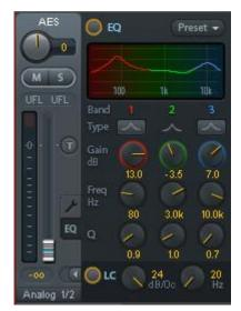
**Lo Cut.** Wird über den Button Lo Cut aktiviert. Die Flankensteilheit des Hochpasses ist einstellbar zwischen 6, 12, 18 und 24 dB pro Oktave. Die Grenzfrequenz (-3 dB) ist einstellbar zwischen 20 Hz und 500 Hz.
