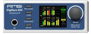
Während der Anzeige des Global Level Meter Bildschirms dient der **Drehgeber** (Encoder) zur schnellen Einstellung der Monitorlautstärke des Main Out. Das Drücken des Knopfes wechselt zur Kontrolle des Phones Volume, wie im unteren rechten Teil des Bildschirms angezeigt.
