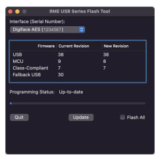
Um die Dauer des Flashvorganges zu verringern aktualisiert das Programm nur die veralteten Teile. Über die Option *Flash All* lässt sich ein Komplettupdate erzwingen.
