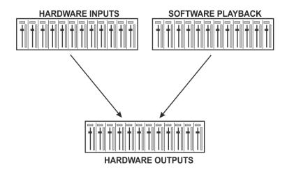
TotalMix kann in der obigen Ansicht (View Options **2 Rows)** platzsparend arbeiten. Default ist jedoch eine vertikale Anordnung wie bei einer Inline-Konsole, wobei die Reihe *Software Playback* dem *Tape Return* eines realen Mischpultes entspricht:
