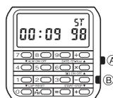
Die Start/Stop-Bedienung wird mit einem Signalton bestätigt. Der Ton ertönt in Intervallen von 10 Minuten. (Messbereich) Die Stoppuhranzeige ist auf 23 Stunden 59 Minuten 59,99 Sekunden begrenzt. Danach kann sie zurückgesetzt und neu gestartet werden. Die Stundenstellen können durch Drücken von Taste (E) angezeigt werden.
