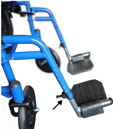
Abb. 1: Einstellung der Unterschenkellänge
