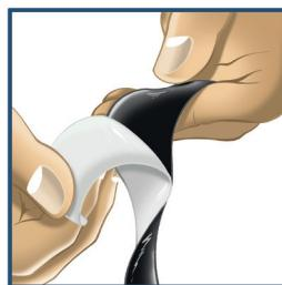
2. Retirez le film du dessus de la bande et placer le ruban adhésif sur l'élément à réparer
