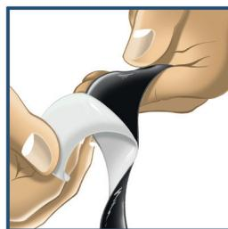
2. Przyłożyć taśmę do elementu, na który ma zostać nawinięta, uprzednio ściągając folię ochronną z górnej strony taśmy.
