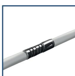
5. Etirez moins le dernier enroulement. Veiller à ce qu'il soit posé à 100% sur la bande. Appuyez sur la bande pendant 10 secondes jusqu'à ce que la bande soit solide.
