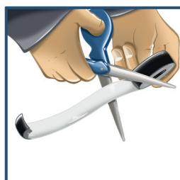
1. Reinigen Sie zunächst die zu behandelnde Oberfläche bzw. das zu reparierende Produkt. Schneiden Sie die erforderliche Menge vom Band ab
