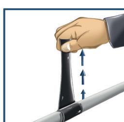
4. La cinta debe ser constantemente muy estirada hasta aprox. 50% y enrollada bajo presión y superposición. Asegúrese de que la cinta se superpona al menos el 50% del ancho (autofusión). En caso de fugas con alta presión o alta tensión, la cinta deberá ser superpuesta alrededor al menos con cinco o seis capas. Para sellar contra la tensión, también se debe usar una cinta aislante de PVC.
