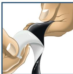
2. Trek de bovenlaag van de tape en plaats de tape op het te repareren element.
