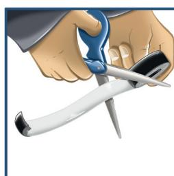
1. Nettoyez d'abord la surface à traiter ou le produit à réparer Coupez la longueur de la bande nécessaire.
