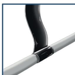
3. Legen Sie das Band an und fixieren Sie es mit dem Daumen. Dehnen Sie das Band und umwickeln Sie die erste Umwicklung komplett überlappend. Dadurch wird die Position des Bandes für weitere Umwicklungen fixiert.
