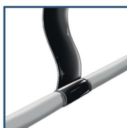
3. Appliquez le ruban adhésif et le fixer avec votre pouce. Étendre la bande et envelopper la première couche en la faisant se chevaucher complètement. Cela permet de fixer la position de la bande pour d'autres enroulements.
