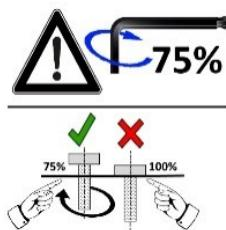
Preste atención de enroscar los tornillos primero a mano y de apretarlos ligeramente, de manera que el tornillo quede sujeto y los elementos estén conectados sin apretar. Hasta que no estén unidos todos los elementos de esta manera, los tornillos no deben apretarse. Apretar posteriormente los tornillos permite ajustar pequeñas desviaciones de las perforaciones o soldaduras que podrían existir en los productos fabricados a mano.
