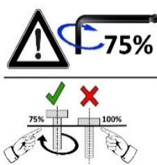
Breng de schroeven aan en draai ze handvast aan, zodat de schroef grijpt en de elementen losjes zijn verbonden. De schroeven mogen pas worden aangedraaid als alle elementen op deze manier met elkaar zijn verbonden. Door de schroeven vervolgens aan te draaien kunnen kleine afwijkingen in de boorgaten of lasnaden worden opgevangen die bij handgemaakte producten kunnen optreden.
