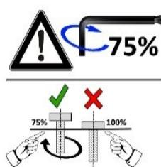
Należy zwrócić uwagę na to, aby najpierw wkładać i tylko lekko dokręcać śruby ręcznie, tak by znalazły one oparcie i luźno łączyły elementy. Śruby można mocno dokręcić dopiero wtedy, gdy wszystkie elementy zostaną ze sobą połączone. Dzięki późniejszemu dokręcaniu śrub można wyrównać niewielkie odchylenia otworów wierconych lub spawów, które mogą powstać w przypadku produktów wykonywanych ręcznie.
