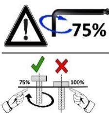
Bitte beachten Sie, dass die Schrauben zunächst von Hand eingesetzt und nur leicht angezogen werden, so dass die Schraube Halt findet und die Elemente locker verbindet. Schrauben dürfen erst fest angezogen werden, wenn alle Elemente in dieser Form miteinander verbunden sind. Durch das nachträgliche Anziehen der Schrauben können kleine Abweichungen der Bohrlöcher oder Schweißstellen, die bei handgearbeiteten Produkten entstehen können, ausgeglichen werden.
