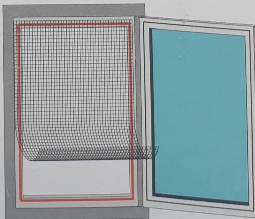
6. Legen sie nun das Lineal auf die Außenkanten des Kettbandes an und schneiden sie den Überstand des Insektengitters mit dem Kattmesser ab.
