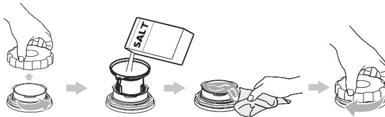
1. Unterkorb entfernen, Deckel des Salzbehälters abschrauben.
