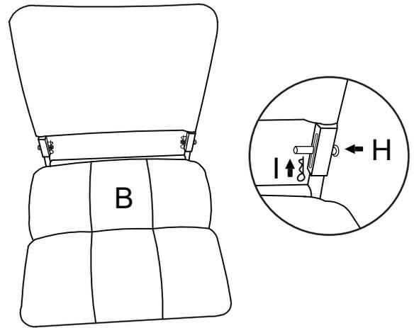
Befestigen Sie die Bolzen #H und R-Clip #I an der Rückenlehne.
