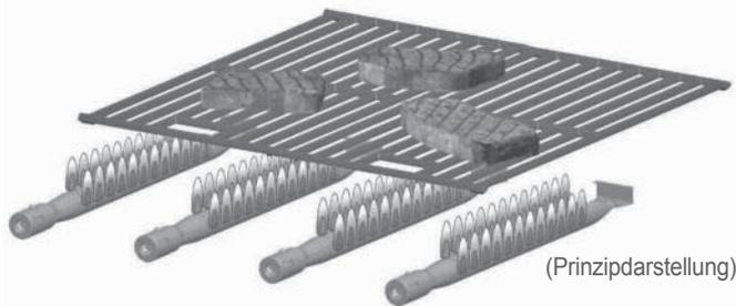
Das direkte Grillen ist die am meisten verbreitete Form des Grillens und wird von vielen als "die Grillmethode schlechthin" bezeichnet. Während des Grillens wird direkt unterhalb des Rostes die Hitze erzeugt und dem Grillgut "direkt" zugeführt.
