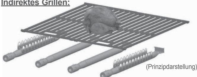
Beim indirekten Grillen wird das Grillgut bei mittlerer / erhöhter Temperatur in einem geschlossenen Grill gegart. Das Grillgut befindet sich
