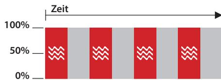
Leistungssteuerung durch Intervalle mit Standard-Mikrowellentechnologie. Beispiel: 50% Leistung (ca. 450 Watt)
