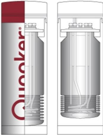
Denn dieses Reservoir hat Platz für Expansionswasser, weil die Kesselwand aus Edelstahl flexibel ist. Ein Teil des Reservoirs ist als **Balg** konzeptioniert, der sich bei jedem Aufheizen des Wassers etwas ausdehnen kann. Sobald Wasser abgezapft wird, schrumpft der Balg in seine Ausgangsposition zurück und ist wieder bereit, frisches Leitungswasser aufzuheizen.
