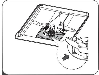
**4** Bauen Sie den Filter in umgekehrter Reihenfolge wieder zusammen, setzen Sie den Filtereinsatz wieder ein und drehen Sie ihn im Uhrzeigersinn bis zur Pfeilmarkierung.
