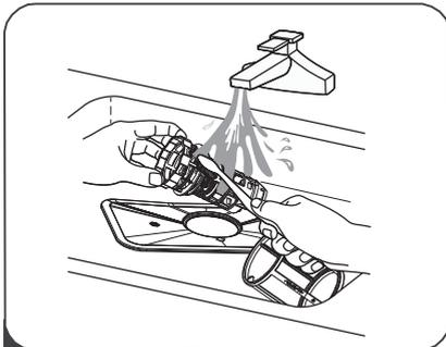
**3** Die Filter können durch Spülen unter fließendem Wasser gereinigt werden. Verwenden Sie zur gründlichen Säuberung eine weiche Reinigungsbürste.
