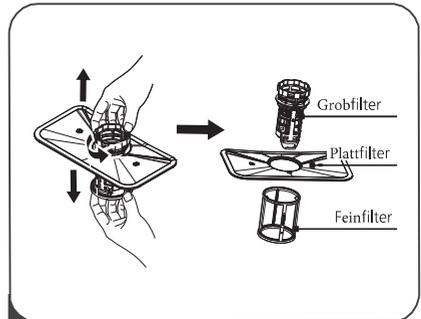
**2** Der Feinfilter kann vom Boden der Filtergruppe abgezogen werden. Der Grobfilter kann vom Hauptfilter gelöst werden, indem Sie die Laschen oben leicht zusammendrücken und wegziehen.
