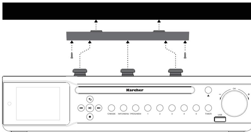
1. Nehmen Sie die Montageplatte vom Gerät ab, indem Sie diese nach hinten schieben.
