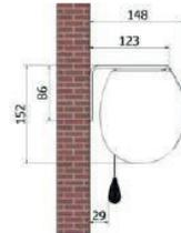
Zeichnen Sie eine Linie, um die beiden Montagebügel in Flucht zu installieren. Nutzen Sie die Montagebügel als Vorlage und markieren Sie die Löcher mithilfe eines Bleistiftes an der Wand. Bohren Sie anschließend gemäß den Markierungen mit einem Bohrer Löcher und führen passende Dübel in die Bohrlöcher ein (die Dübel müssen dabei stramm in den Löchern sitzen). Befestigen Sie die Montagebügel mit passenden Schrauben an der Wand.
