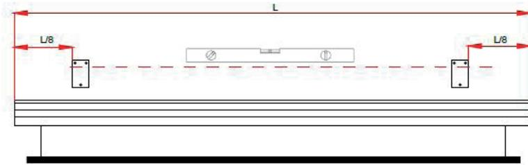
Messen Sie die Länge des Gehäuses und teilen Sie diesen Wert durch 8 und platzieren Sie die Montagewinkel gemäß obiger Zeichnung.
