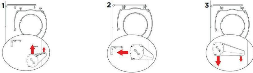
Heben Sie nun das Leinwandgehäuse mit zwei Personen an und führen es vorsichtig in die Montagebügel ein. Achten Sie darauf, dass die Gehäuseprofile in die Haken der Montagebügel greifen. Lassen Sie das Gehäuse nun langsam nach unten gleiten und lassen erst dann los, wenn das Gehäuse vom Bügel (in jeweils beiden Hakennasen) tatsächlich gehalten wird.
