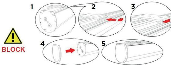
Eine sichere Montage ist ausschließlich gewährleistet, wenn die beiliegenden Kunststoff Sicherungen (im oberen Bild rot eingezeichnet) an jedem Montagewinkel von vorne gemäß obiger Zeichnung eingesetzt werden. Wichtig ist, dass diese beim Einsetzen spürbar arretieren.
