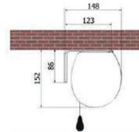
Zeichnen Sie eine Linie, um die beiden Montagebügel in Flucht zu installieren. Nutzen Sie die Montagebügel als Vorlage und markieren Sie die Löcher mithilfe eines Bleistiftes an der Decke. Bohren Sie anschließend gemäß den Markierungen mit einem Bohrer Löcher und führen passende Dübel in die Bohrlöcher ein (die Dübel müssen dabei stramm in den Löchern sitzen). Befestigen Sie die Montagebügel mit passenden Schrauben an der Decke.
