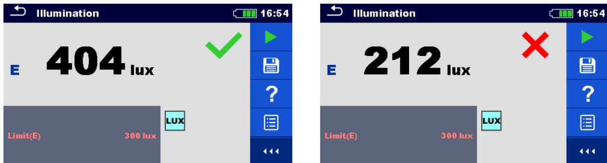
Abbildung 7.123: Beispiele für Ergebnisse Beleuchtungsstärkemessung
