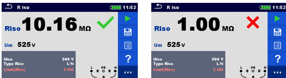
Abbildung 7.9: Beispiele für Ergebnisse der Isolationswiderstandsmessung
