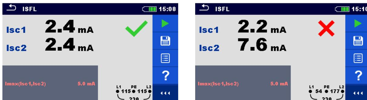
Abbildung 7.114: Beispiel für die Messergebnisse Fehlerstrom des ersten Fehlers
