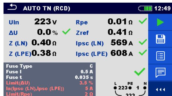
Abbildung 7.133: Beispiele für Ergebnisse der AUTO TN (RCD) Messung
