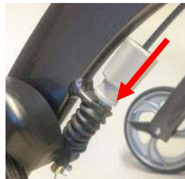
2. Bowdenzug nachspannen durch drehen gegen den Uhrzeigersinn oder lockern durch Drehen im Uhrzeigersinn.
