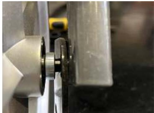
Das Bild zeigt die Achsaufnahme des Hinterrads und die Montage der Ankipphilfe.
