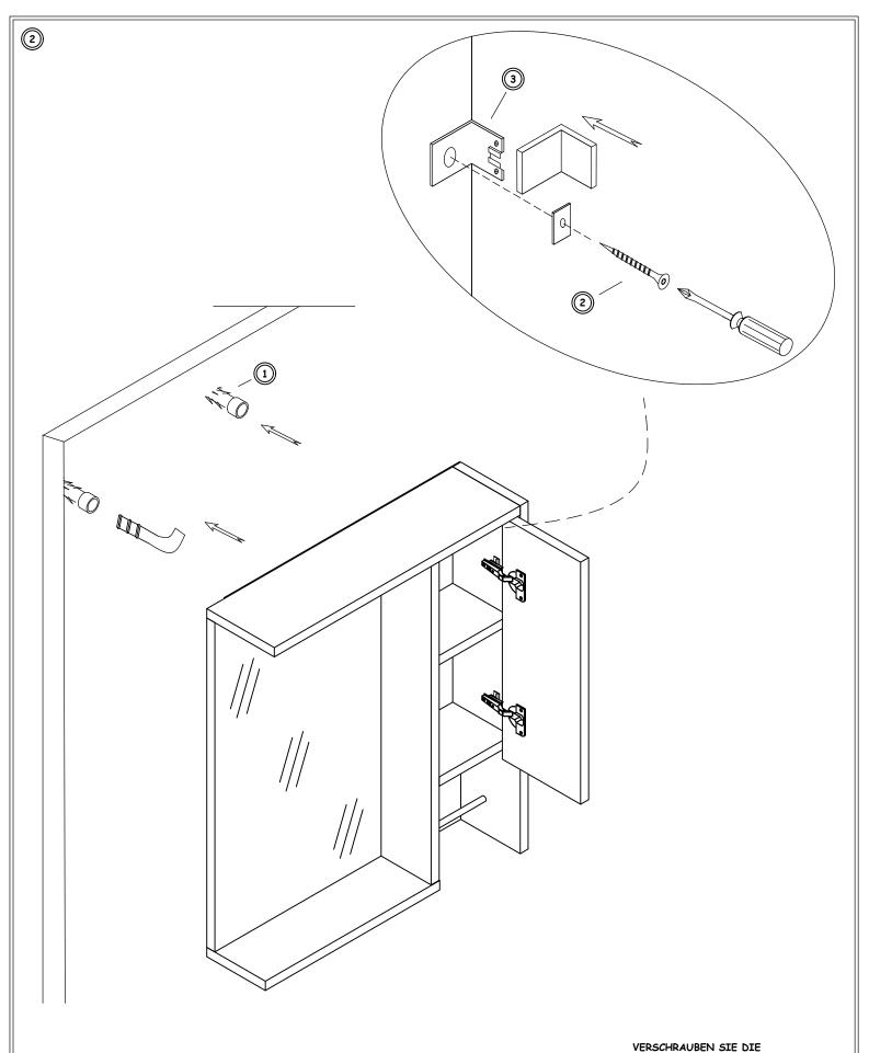
SCHRAUBEN SIE DEN SCHRAUBHAKEN IN DEN VORHER ANGEBRACHTEN DÜBEL. HÄNGEN SIE DAS AN DER RÜCKSEITE DES SCHRANKS BEFESTIGTE AUFHÄNGUNGSELEMENT AN DEN HAKEN DES AUFHÄNGUNGSELEMENTE IN DIE
