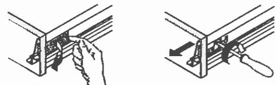
Höhenverstellung / Height adjustment / Réglage en hauteur / Hoogteverstelling
