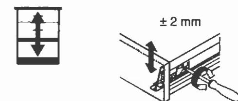
Seitenverstellung / Side adjustment / Réglage latéral / Zijdelingse verstelling
