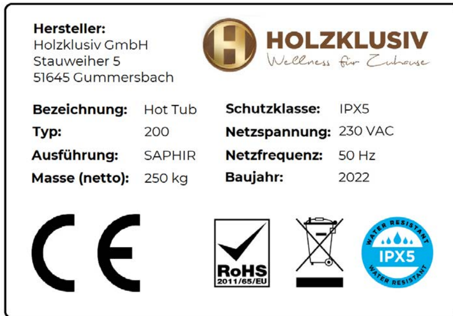
Abbildung 7: Typenschild, dargestellt für die Ausführungsvarianten SAPHIR und dem Typen 200
