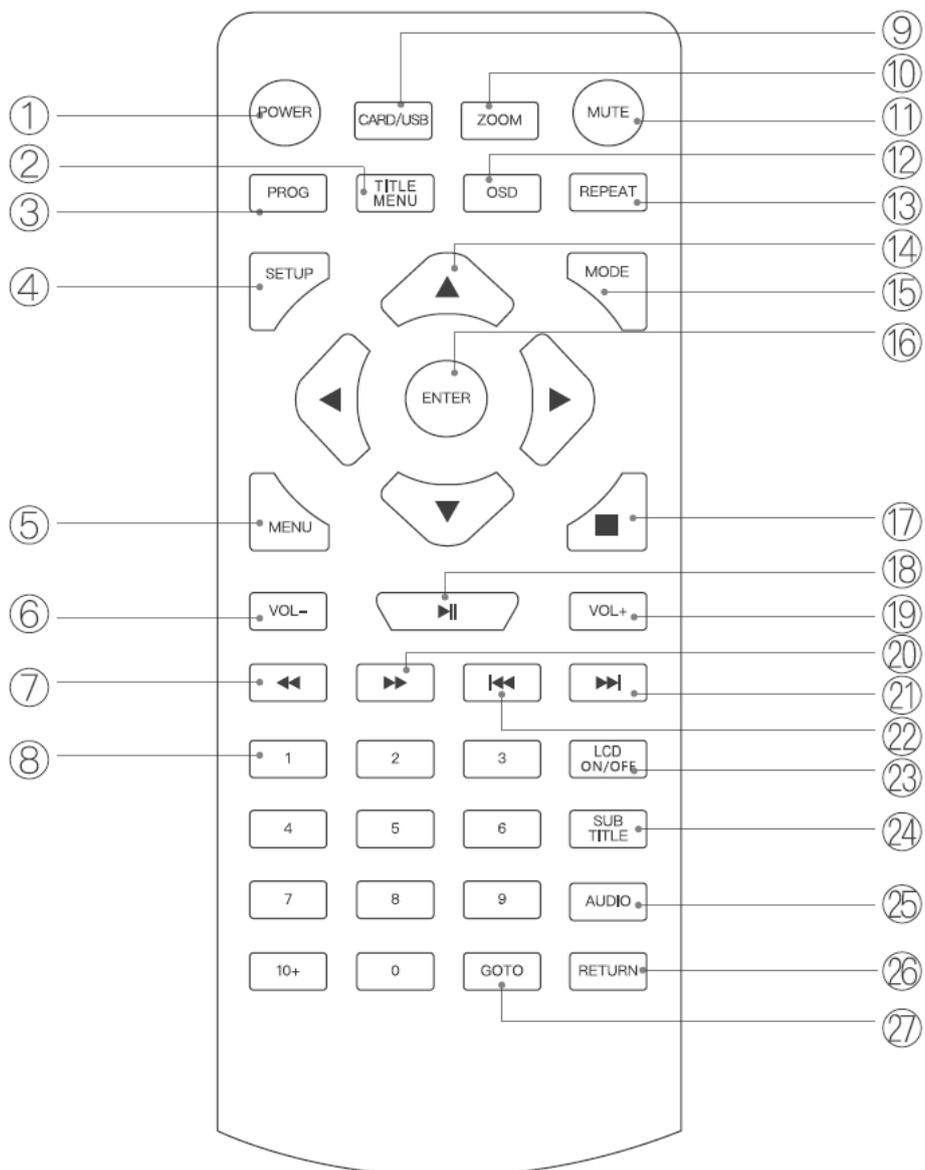
Die Fernbedienung benutzt Infrarotwellen (IR). Halten Sie die Fernbedienung in die Richtung des TV Gerätes. Befindet sich die Fernbedienung außerhalb der Reichweite bzw. des Winkels, kann es vorkommen, dass die Fernbedienung nicht ordnungsgemäß funktioniert. Um ein Auslaufen der Batterien zu vermeiden entnehmen Sie die Batterien aus der Fernbedienung, wenn das Gerät für einen längeren Zeitraum nicht genutzt wird.
