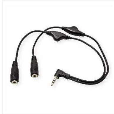
**Lautsprecher-Y-Kabel zum Anschluss zweier Lautsprecher oder Kopfhörer an einen Lautsprecher-Ausgang; 1x 3,5mm Stecker (Mini-Klinke), 2x 3,5mm Buchse (Mini-Klinke).**
