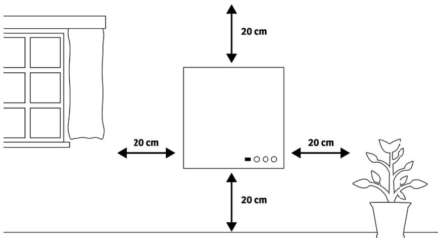
Das Heizgerät muss mindestens 20 cm von allen Gegenständen, Wänden, der Decke und dem Boden entfernt sein.
