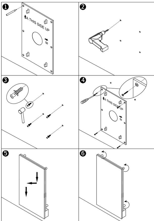
1. marquer la position des trous sur le mur à l'aide du gabarit fourni
