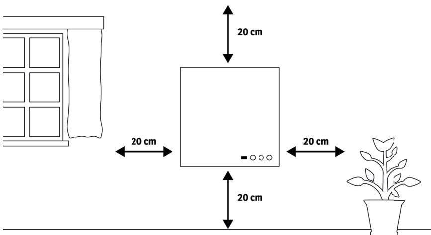
Le chauffage doit être éloigné d'au moins 20 cm de tout objet, des murs, du plafond et du sol.
