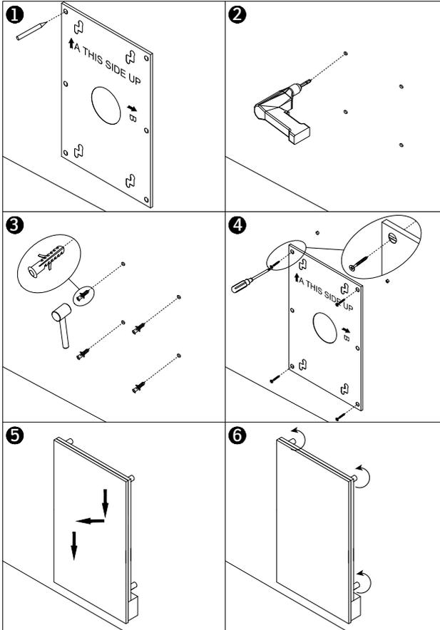
1. Markieren Sie mit der mitgelieferten Schablone die Position der Löcher an der Wand.
