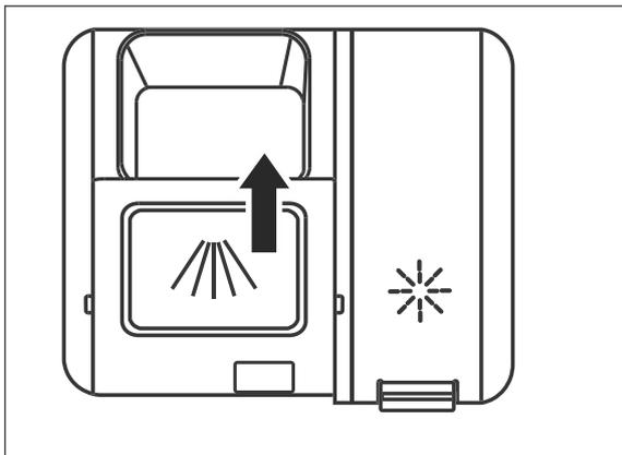
4. Schließen Sie die Klappe, indem Sie sie nach vorne schieben und dann nach unten drücken.
