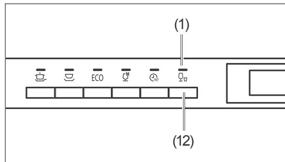
2. Halten Sie die Taste (12) so lange gedrückt, bis das Display den aktuellen Härtegrad anzeigt (H1 bis H6).
