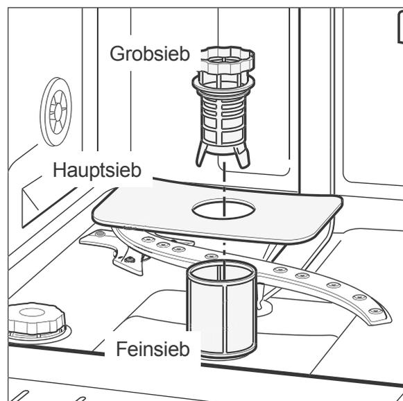
Überprüfen Sie nach jedem Spülgang das Grobsieb, das Hauptsieb und das Feinsieb, und entfernen Sie ggf. Speisereste und Fremdkörper:
