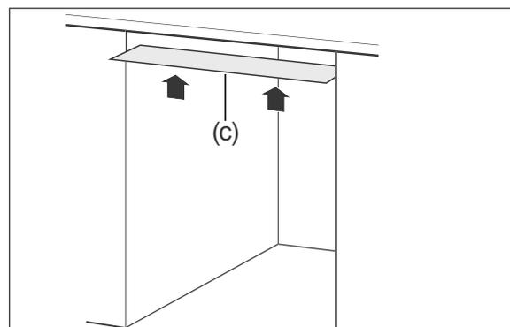
3. Kleben Sie die beiliegende Schutzfolie (c) auf die Unterseite der Arbeitsplatte. So vermeiden Sie Schäden an der Arbeitsplatte aufgrund heißer Dämpfe, die bei geöffneter Tür aus dem Geschirrspüler strömen.
