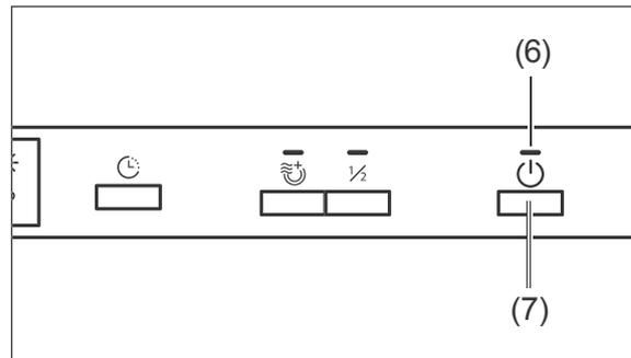
1. Öffnen Sie die Gerätetür und schalten Sie den Geschirrspüler mit der Taste (7) ein. Die LED (6) leuchtet.
